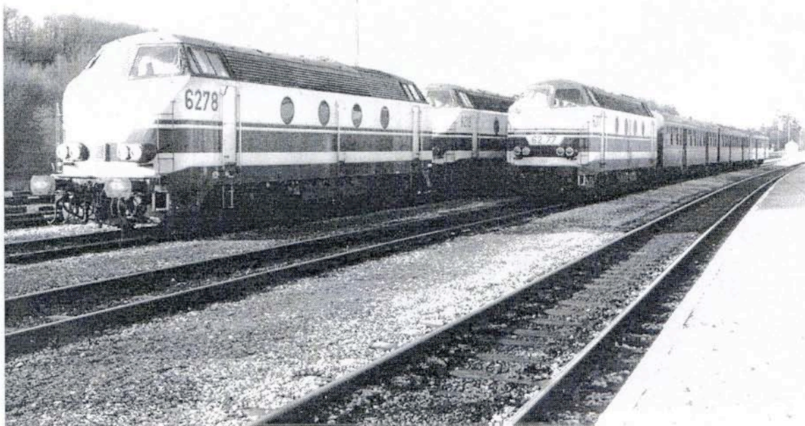
Les locomotives diesel de la série 62 parcourent la ligne 132. Ici au garage à Walcourt, le 28 février 99. Prêtes au départ pour assurer les trains P du lundi matin, les 6278 et 6218 en voie 5, la 6277 en voie 4. Sur chaque voie une série de 3 voitures M2. Les voies 1 et 2 restent libre pour le passage des rares convois du dimanche. Le quai à droite donne accès aux voies 2 et 1. (photo Claude Carpet).
